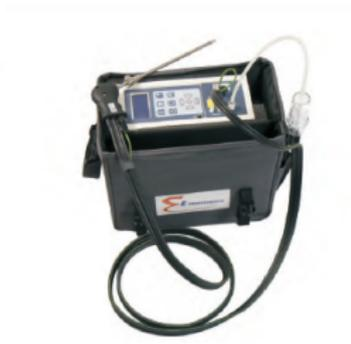
**Figure:** Analizador de emisiones de gases de combustión
