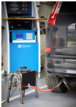
**Figure:** Analizador de emisiones de gases de combustión
