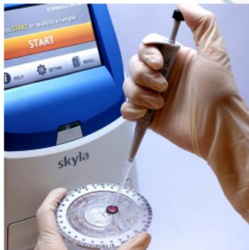
Figure: Analizador automático de bioquímica
