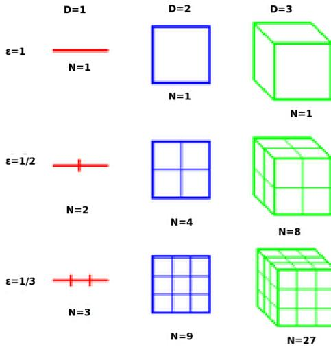
**Figura 3:** Representação da relação entre o número de caixas, a medida utilizada (lado  $\epsilon$  da caixa) e o número de dimensões do objeto.
