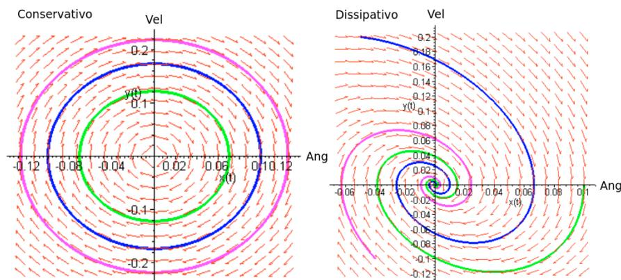
**Figura 1:** Espaço de Fase de um pêndulo conservativo e dissipativo, respectivamente, orbitas elípticas e espirais.
