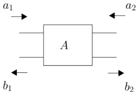
$$\begin{pmatrix} a_1 \\ b_1 \end{pmatrix} = \begin{bmatrix} T_{11} & T_{12} \\ T_{21} & T_{22} \end{bmatrix} \cdot \begin{pmatrix} a_2 \\ b_2 \end{pmatrix} \quad (2)$$
