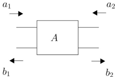
$$\begin{pmatrix} b_1 \\ b_2 \end{pmatrix} = \begin{bmatrix} S_{11} & S_{12} \\ S_{21} & S_{22} \end{bmatrix} \cdot \begin{pmatrix} a_1 \\ a_2 \end{pmatrix} \quad (1)$$
